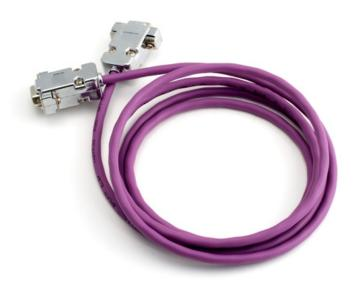
이러한 케이블들은 CAN 버스를 조립하는데 필요하며 특별히 CAN 환경에서 사용되도록 설계되었습니다. 만약 두 개의 고속 CAN 허브들 사이에 간단한 직접 연결이 필요하다면, 종단(termination)이 통합되어 있는 PCAN cable 2 가 사용될 수 있습니다. PCAN cable 2 는 분기(branch) 연결과 별개의 종단 (PCAN-T 아답터와 PCAN-Term 제품) 을 포함하는 CAN 버스를 결합하는데 적합합니다.
