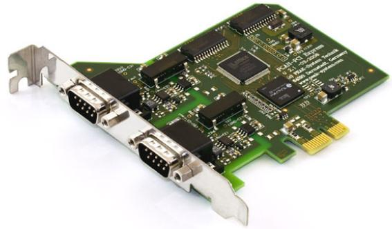
이 카드는 단일 채널 또는 이중 채널 버전으로 이용하실 수 있습니다. 또한 PCAN-PCI Express optodecoupled 버전에는 opto-decoupling 이 포함됩니다. 내장되어 있는 DC/DC 컨버터와 광절연체(optocoupler)는 PC 와 CAN 사이의 최대 500V 의 전기적 절연(galvanic isolation)을 보증합니다.
