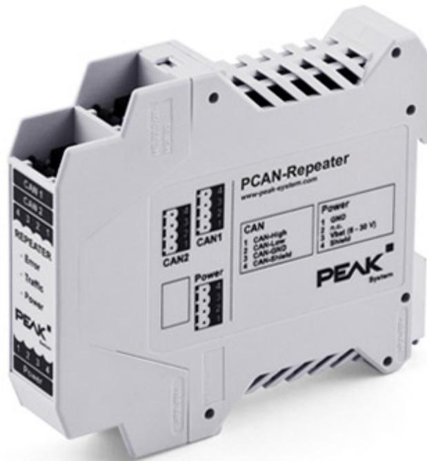
PCAN-Repeater 는 두 개의 고속 CAN 버스들을 연결하며 최대 5 kV 의 galvanic isolation 이 가능합니다. 두 개의 CAN 채널들은 모두 서로간에 그리고 전원 장치로부터 decouple 됩니다. CAN 메시지들은 두 개의 채널들 사이에서 1:1 로 전달되며 필요한 경우는 한쪽 방향으로만 전달될 수도 있습니다. LED 에는 현재의 버스 상태가 표시됩니다. DIN rail 케이스와 넓은 온도 범위 지원으로, 이 모듈은 산업 환경에서 사용하기에 적합합니다.
