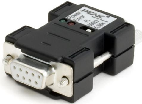
버스 컨버터 PCAN-TJA1054 는 (필립스의 PCA82C250, PCA82C251 과 TJA1050 트랜시버들을 기초로 한) CAN 고속 컴포넌트들, 예를 들면 PCAN-USB 또는 PCAN-PCI 카드를 저속 CAN 버스 ( PCA82C252, TJA1053, TJA1054)에 연결합니다. 버스 컨버터의 5V 공급은 9-pin D-Sub 소켓의 pin1 을 통해 이루어집니다.
