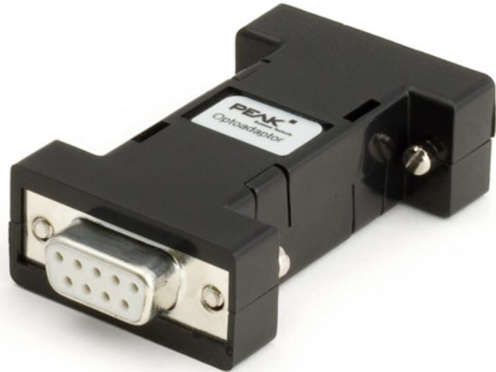
PCAN-Optoadaptor 는 CAN 버스 시스템을 전기적으로 decoupling 하기 위한 범용의, 플러그-인 광 아답터입니다. 이것의 통합 로직은 decoupling 이 CAN 네트워크의 임의 지점에서 설치될 수 있다는 것을 뜻합니다.
