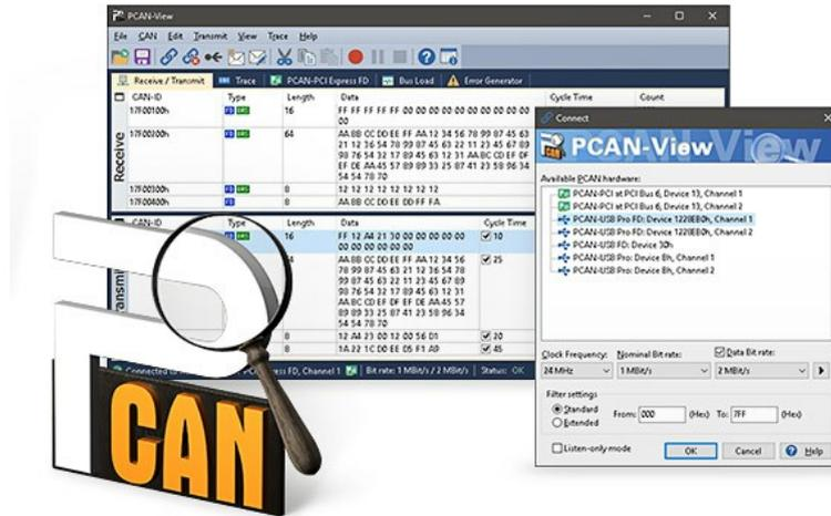
윈도우용 소프트웨어 PCAN-View 는 모든 PCAN-PC 하드웨어 패키지에 포함되어 있는 CAN 모니터로, PCAN- PC 아답터와 결합하여 CAN 메시지를 표시할 수 있습니다.
