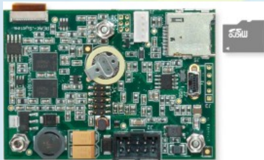
PCAN-MiniDisplay의 회로 보드의 microSD 카드 슬롯의 위치(아래 보기)
